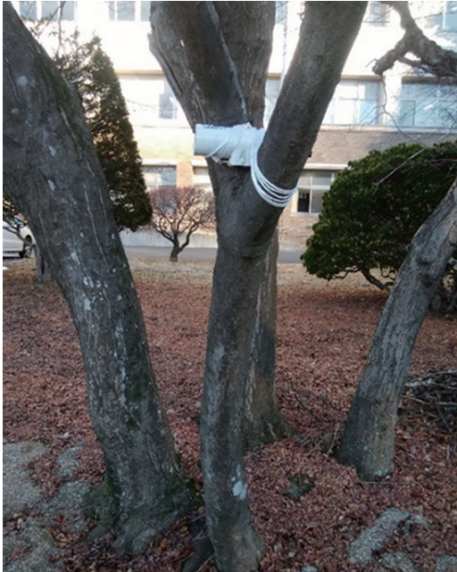
図3 温度計の設置状況
